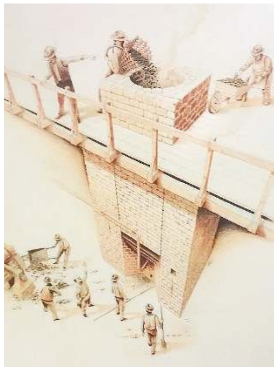
Schema del Forno Fusorio. Come funzionava l'impianto di Tavernole sul Mella
